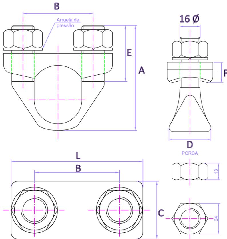
**Figura 1 – Grampo U para Fixação de condutores**
